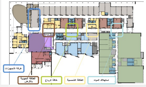
شكل (٢٤) يوضح توزيع أنظمة التحكم ومراقبة الطاقة على مستوى المدرسة. (المصدر: Corgan Associates, 2012)
